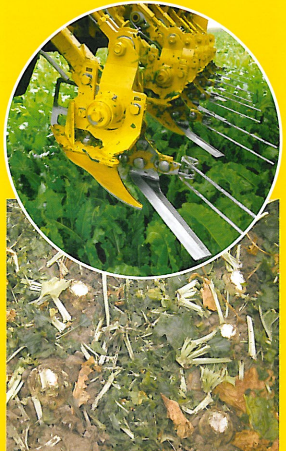
Die Rübenblätter werden mit einem scharfen Messer vom Rübenkörper »abrasiert«.
